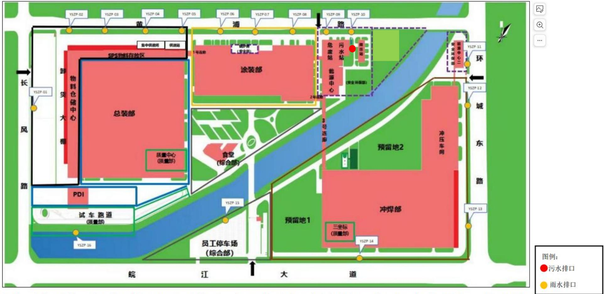
图 3.1-4 项目雨污水管线图
